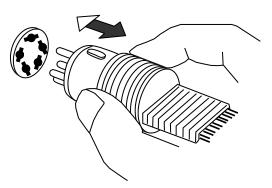
注意 ケーブルの抜き差しは、必ずプラグを持って行ってください。 Be sure to hold the plug when inserting or pulling out the cable.
